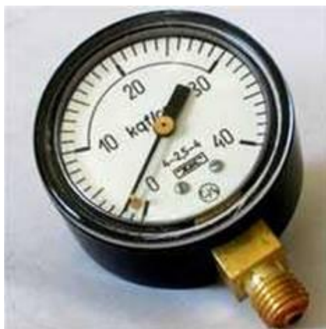
Рисунок 1 - общий вид манометров, мановакуумметров показывающих МТП-М, МВТП-М
