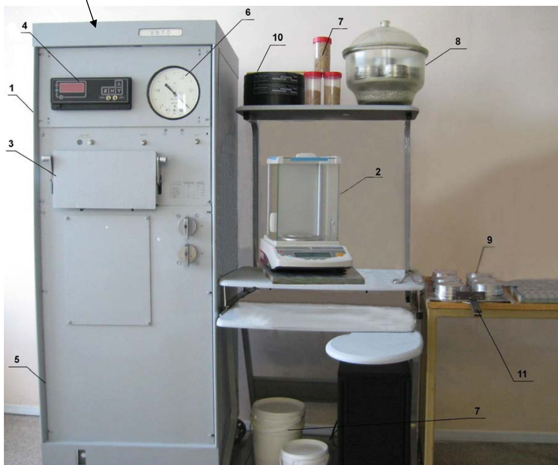
Рисунок 1 - Фото общего вида установки измерительной эталонной вакуумно-тепловой 1 разряда массовой доли влаги в твердых веществах и материалах УВТО-М
