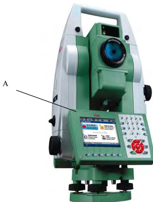
Место пломбирования панели тахеометра электронного Leica TS11.
