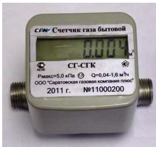
Рисунок 1 - Общий вид счётчика газа бытового СГ-СГК
