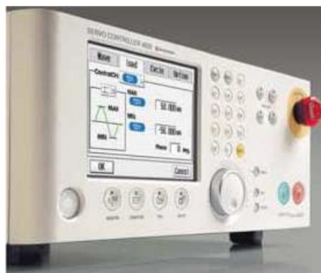
Рис. 4. Общий вид электронного блока управления
