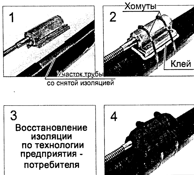
Рисунок 2.5 – Порядок работ по установке и креплению ППТП подземного исполнения с корпусом типа «К2» на трубопроводе с помощью КМЧ
