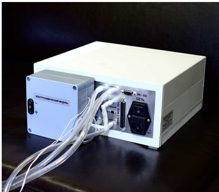
б) блок управления и пневматики с электрохимическим модулем, вид сзади
