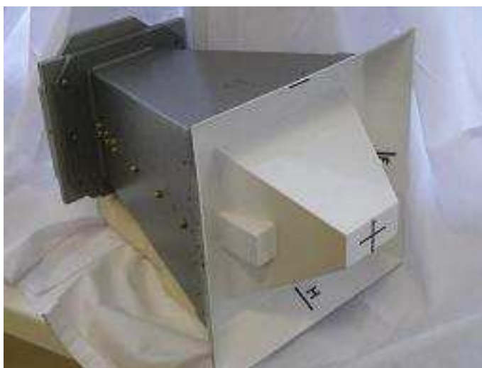
Рисунок 1- Фотография общего вида антенны Место пломбировки от несанкционированного доступа выделено рамкой на рисунке 2.
