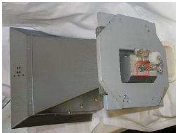
Рисунок 2 - Пломбировка от несанкционированного доступа
