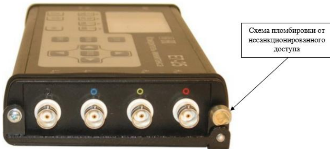
Рисунок 2 — Схема пломбировки от несанкционированного доступа
