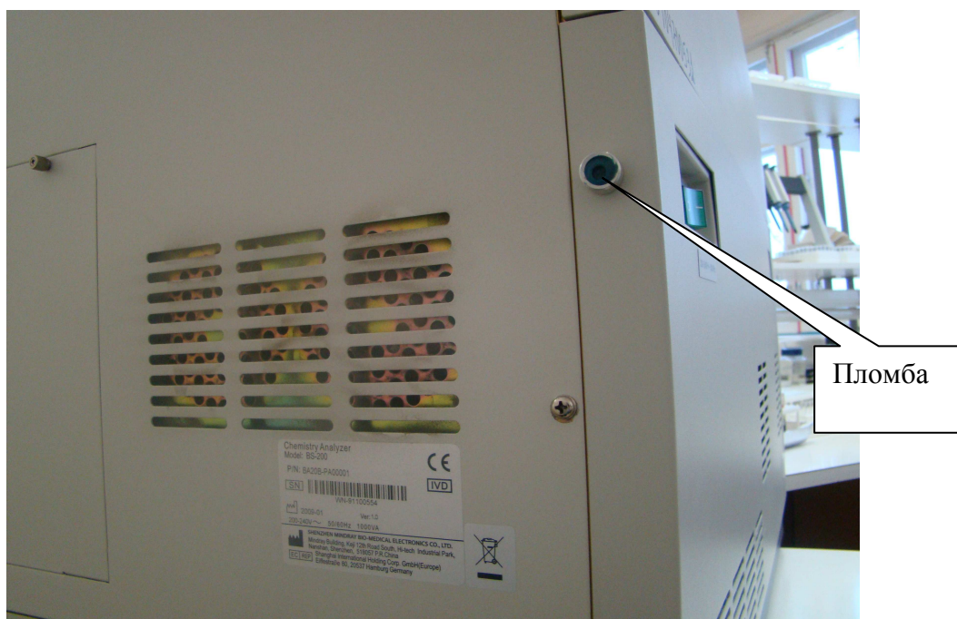
Рисунок 2 – Анализатор автоматический биохимический BS-200, расположение пломбы, закрывающей доступ к органам настройки
