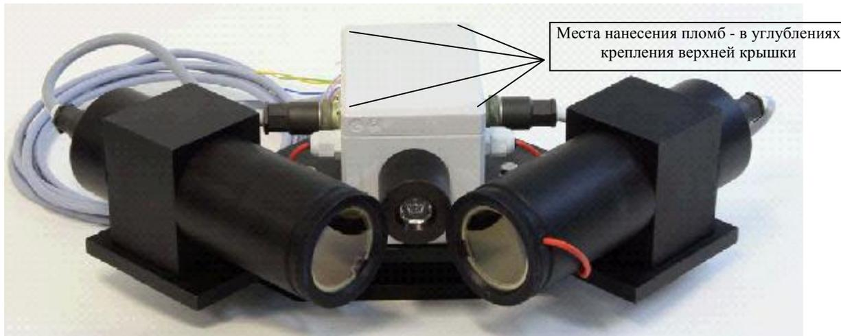
Рис. 1. Общий вид измерителя и схема пломбировки.
