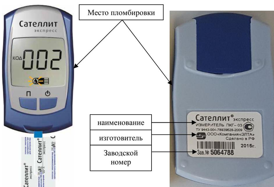
Рисунок 2 - Схемы пломбировки от несанкционированного доступа и маркировки
