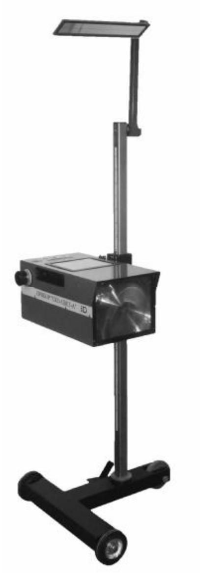
Рисунок 1 - Прибор для измерения параметров света фар транспортных средств СКО-СВЕТ-А
