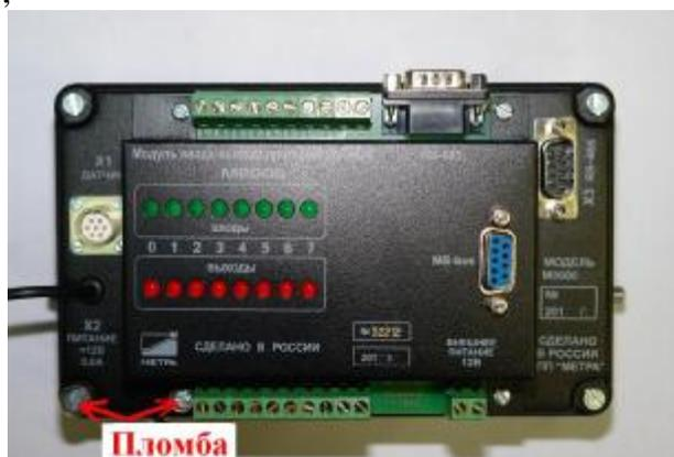
Рисунок 2- Места пломбирования весов
