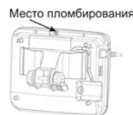
Место пломбирования весов Штрих МП (исполнение Ф4)
