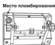
Место пломбирования весов Штрих МП (исполнения Ф1, Ф2, Ф3)
