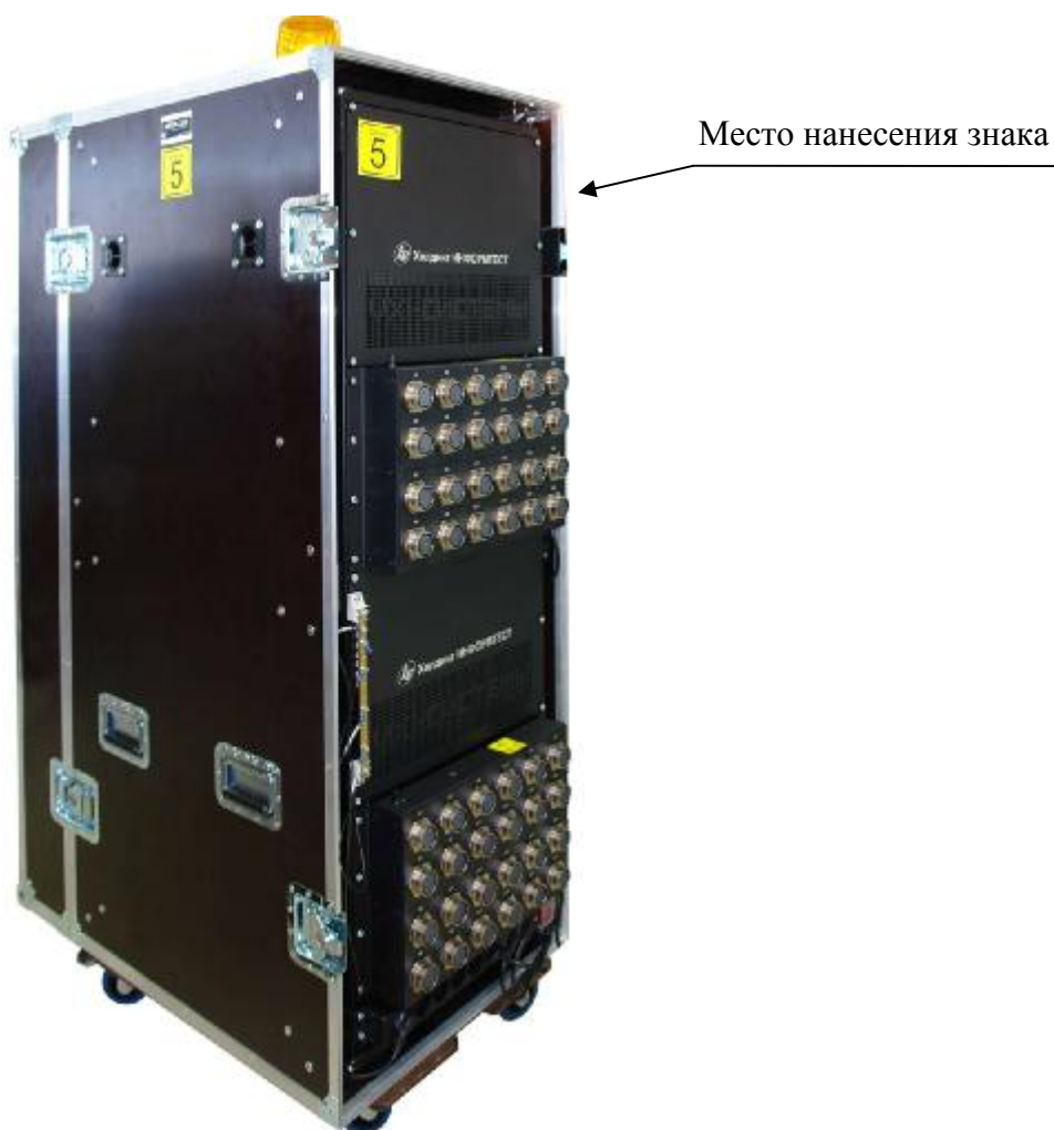
Рисунок 1 – Внешний вид системы, включающей до 4600 каналов
