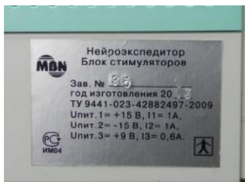
Рисунок 12. Фотография этикетки Нейроэкспедитора: блока электроаудиостимулятора
