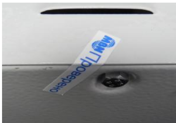
Рисунок 5. Защитная наклейка от несанкционированного доступа блока питания ИБП-01-6
