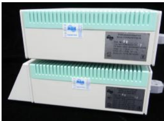
Рисунок 10. Защитные наклейки от несанкционированного доступа Нейроэкспедитора: блока усилителя и блока электроаудиостимулятора (пр.)
