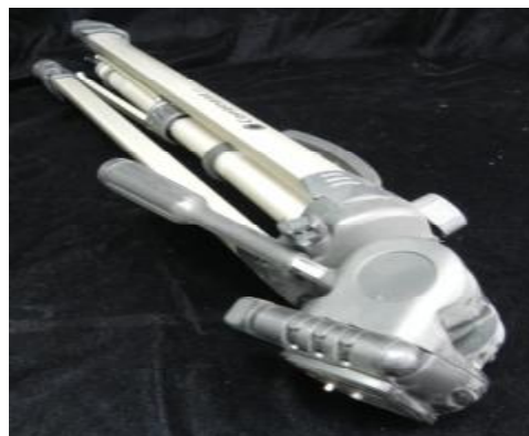
Рисунок 15. Штатив приборный ШК-01-3МММ
