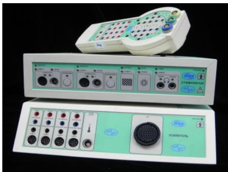
Рисунок 3. Общий вид «Нейроэкспедитор» мод. 3 «ЭЭГ16-ЭМГВП4» с блоком пациента ЭЭГ16
