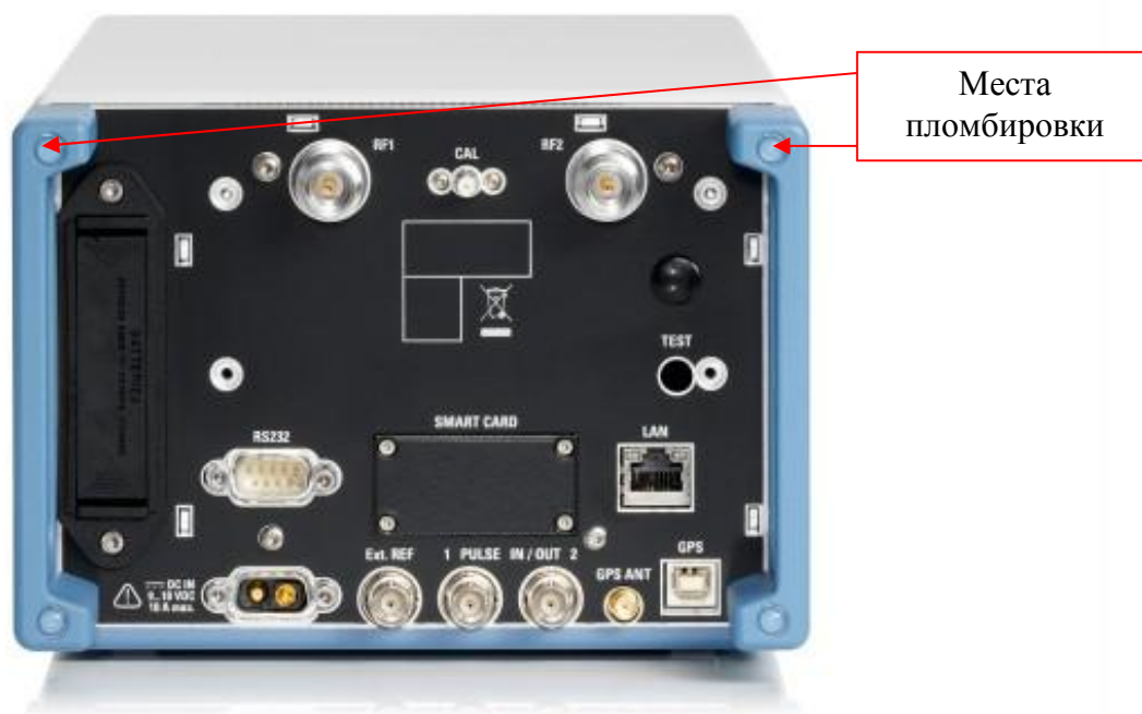
Рисунок 2 - Схема пломбировки от несанкционированного доступа
