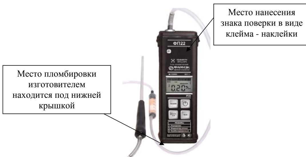
Рисунок 1 - Фотографии внешнего вида и схема пломбировки газоанализатора ФП22 для защиты от несанкционированного доступа с указанием места для нанесения знака поверки
