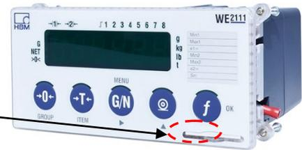
Рисунок 7 — Схема пломбировки приборов весоизмерительных
