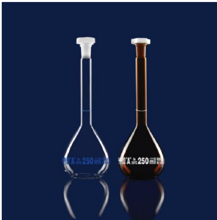
Рисунок 1 – Колбы мерные стеклянные с одной отметкой класса точности А.
