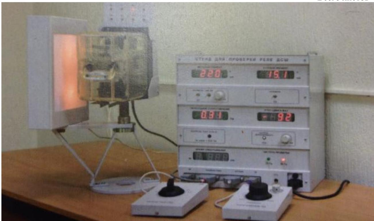
Рисунок 1. Общий вид стендов проверки параметров реле ДСШ «ДСШК»
