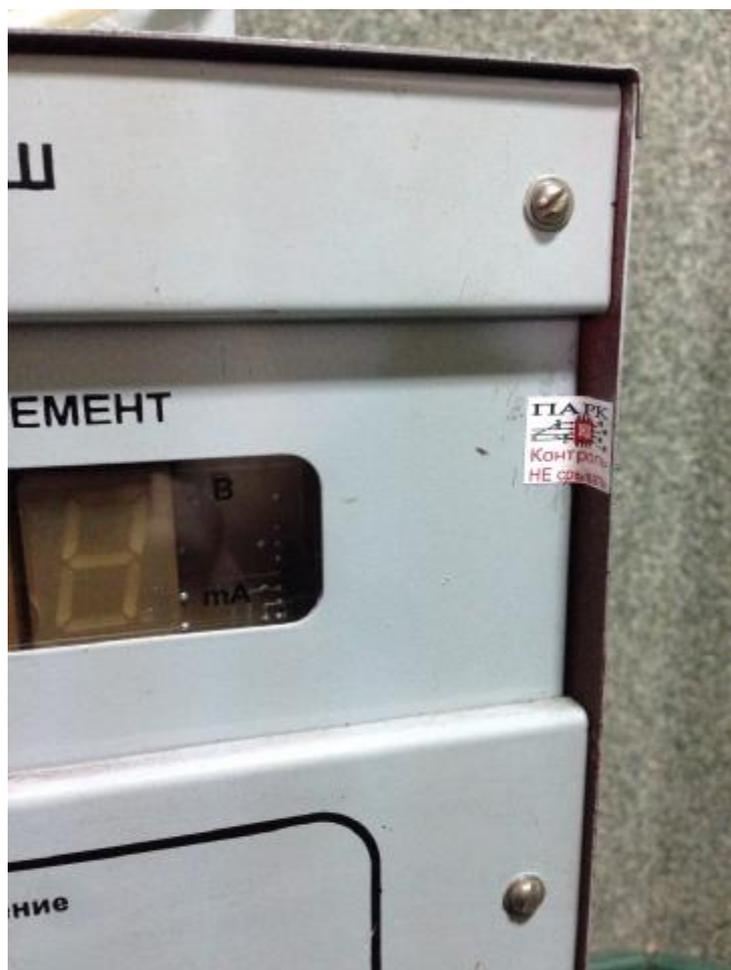
Рисунок 2. Место нанесения заводской пломбы.
