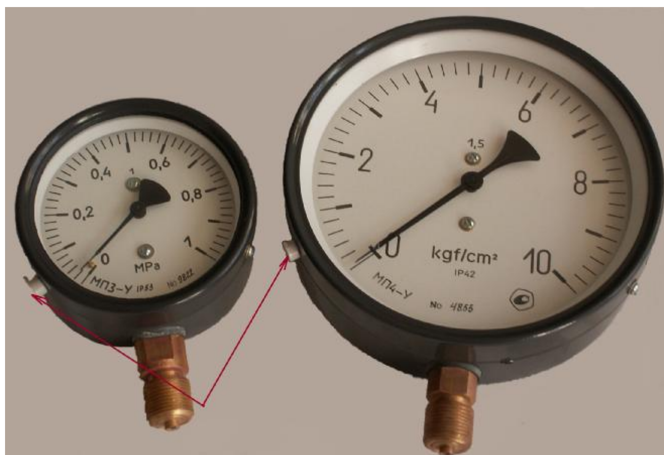
Рисунок 4 - Места пломбировки приборов
