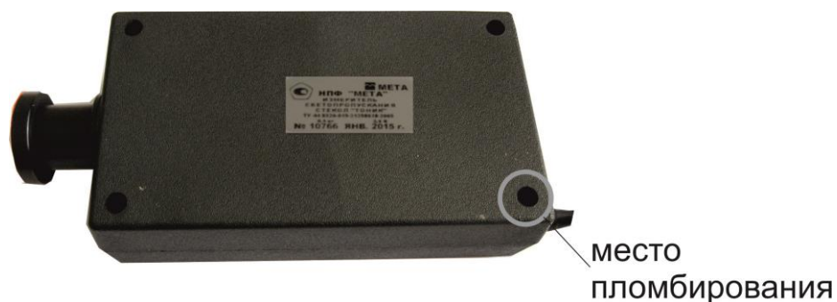
Рисунок 2 – Место пломбирования прибора от несанкционированного доступа
