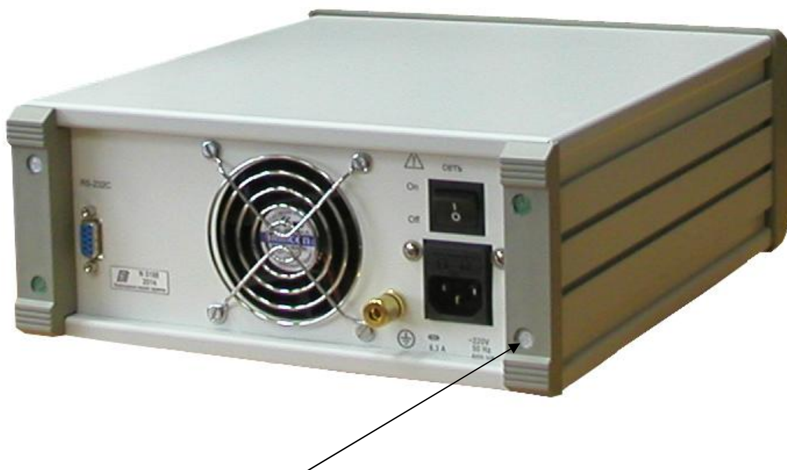
Рисунок 2. Места нанесения поверительного клейма
