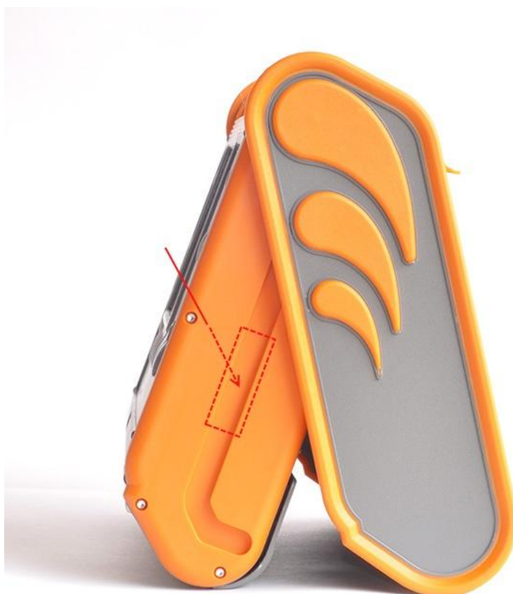
Рисунок 7. Место пломбирования MPI-520, MPI-525.
