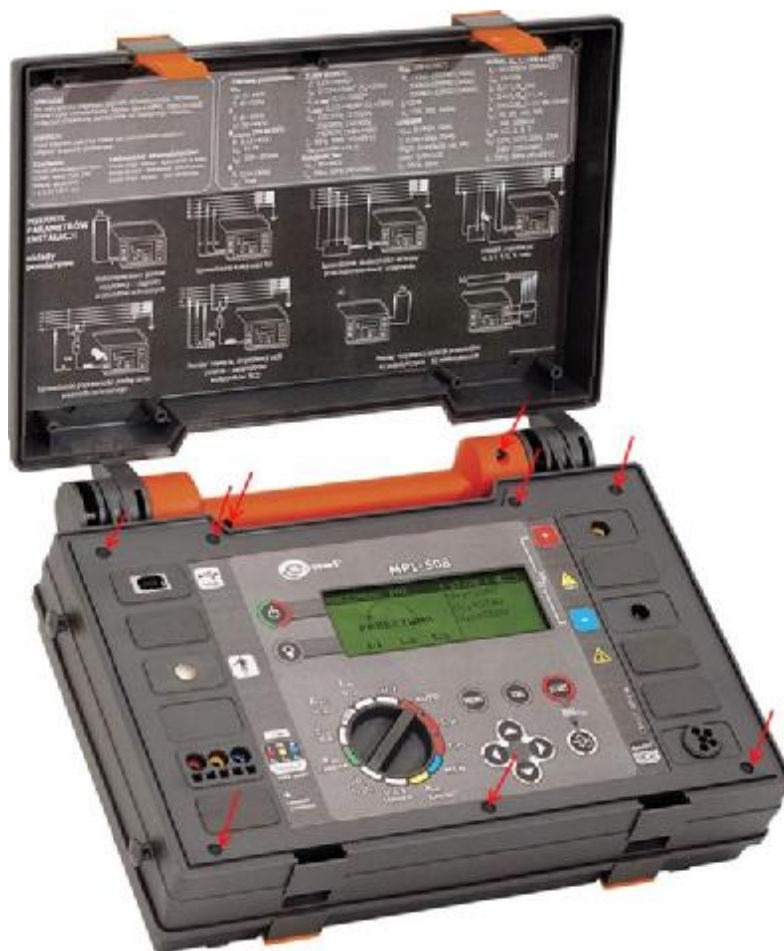
Рисунок 6. Место пломбирования MPI-508.
