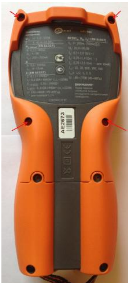
Рисунок 2. Место пломбирования MPI-502.
