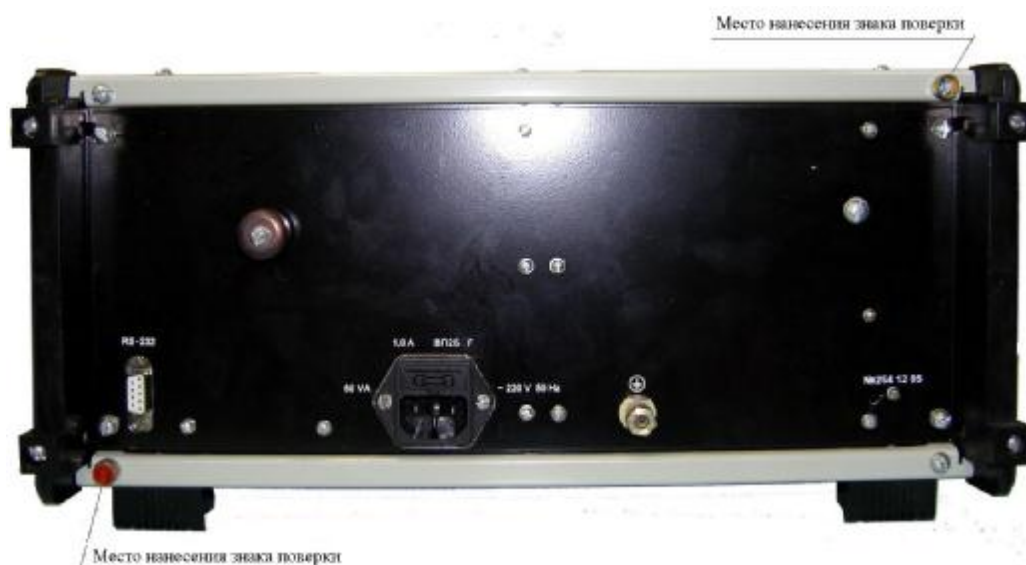
Рисунок 2 – Схема пломбировки от несанкционированного доступа, обозначение мест нанесения знака поверки
