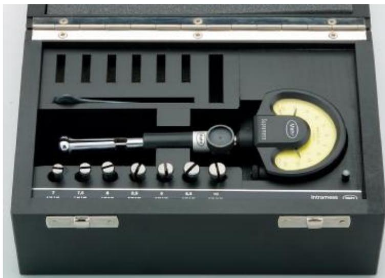
Рисунок 1 – Общий вид Нутромеров самоцентрирующихся 844К
