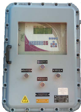
Рисунок 3 - Общий вид ИВК во взрывозащищенном корпусе
