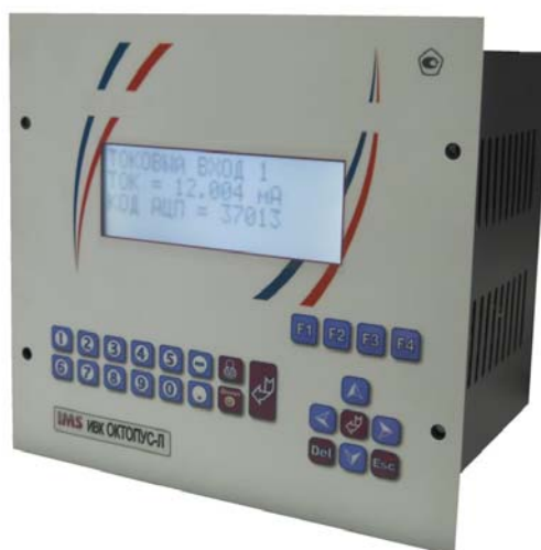
Рисунок 2 - Общий вид ИВК в моноблочном исполнении
