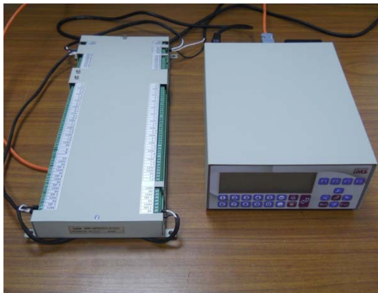
Рисунок 1 - Общий вид ИВК в стандартном исполнении
