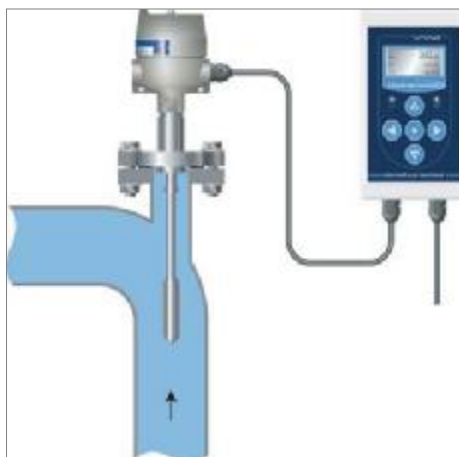
рис. 1 Вид вискозиметра с электронным блоком VP550
