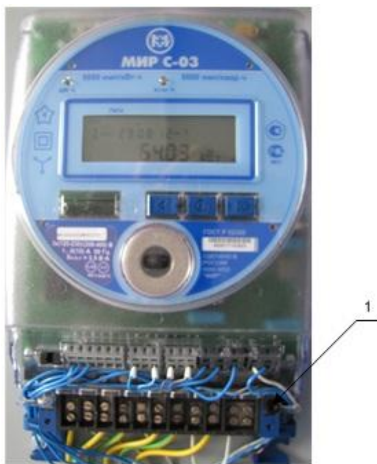
Рисунок 2 – Внешний вид и схема пломбирования прибора на предприятии-изготовителе «МИР С-03»
