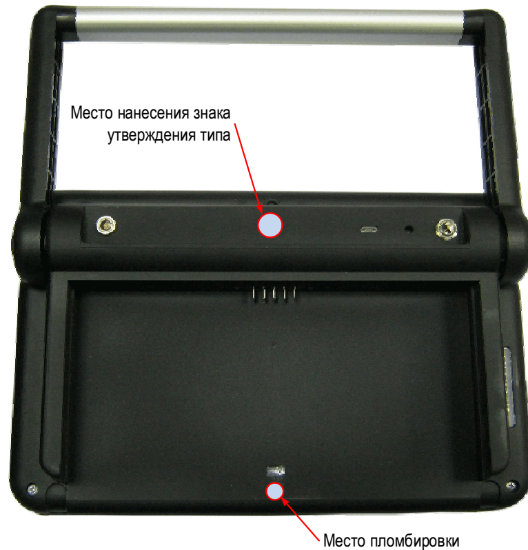
Рисунок 2 – Место пломбировки корпуса дефектоскопа и место знака утверждения типа
