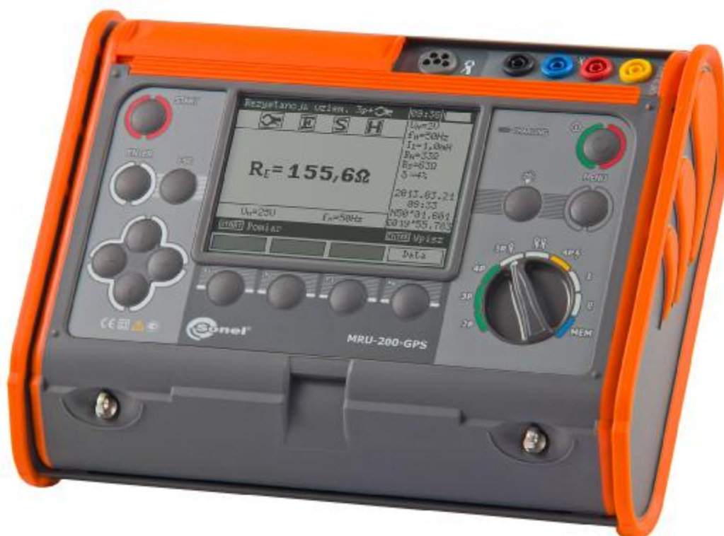
Рис. 5 – Внешний вид MRU-200 в исполнении с приемником GPS
