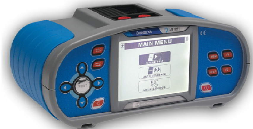
Измеритель параметров электроустановок MI 3105
