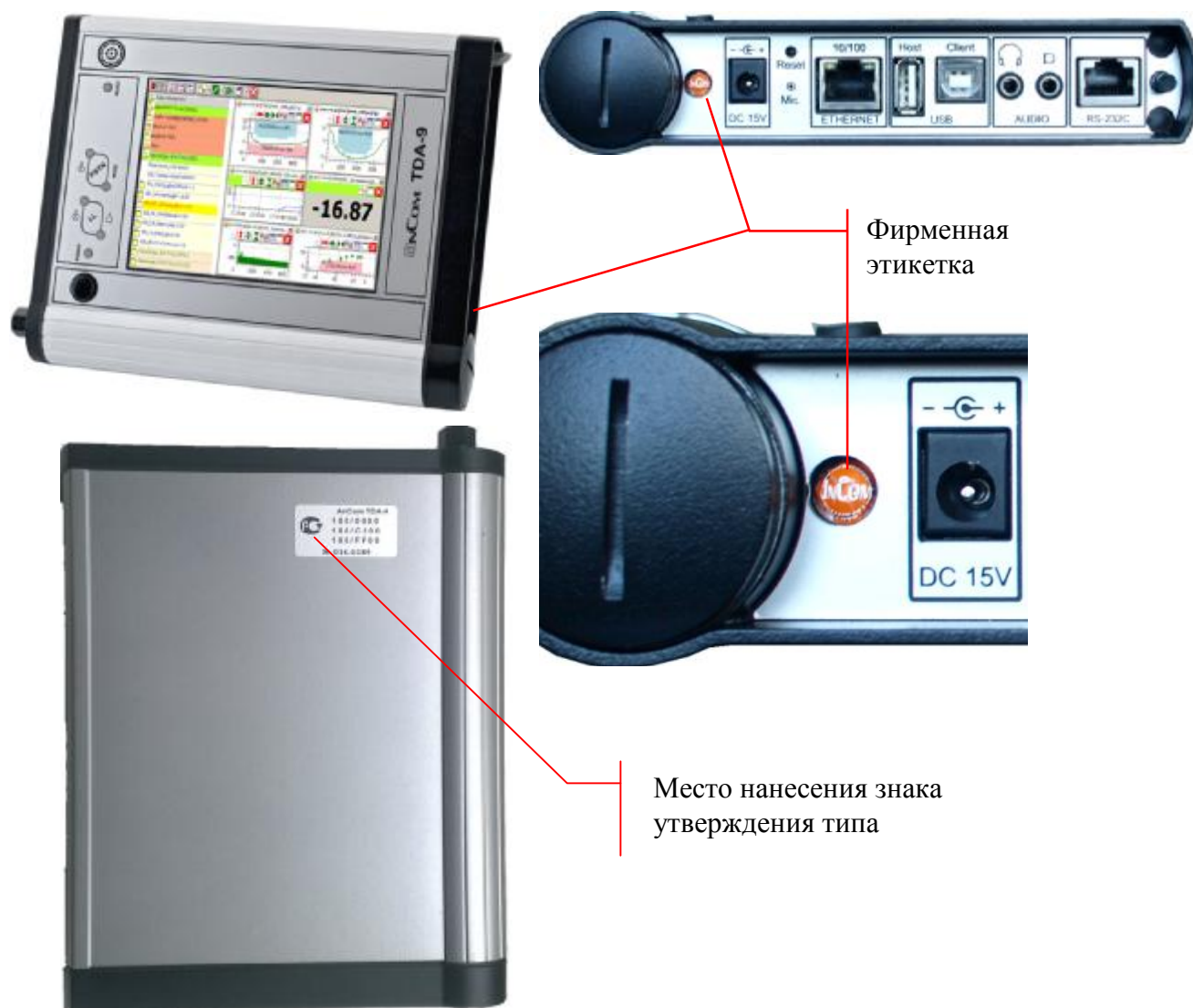
Рисунок 1. Внешний вид анализаторов, место нанесения знака утверждения типа и схемы защиты от несанкционированного доступа
