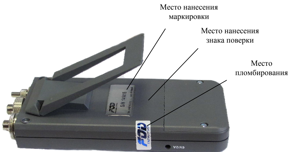
Рисунок 1 - Тестер оптический FOD-1208 – вид сзади
