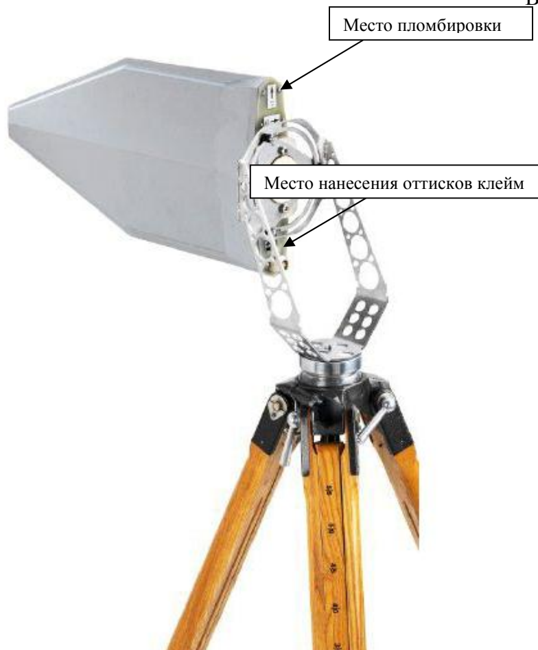
Рисунок 2 - Схема пломбировки от несанкционированного доступа и нанесения оттисков клейм
