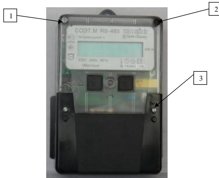
Рисунок 1 – Фотография общего вида счетчиков электрической энергии СОЭТ, где
