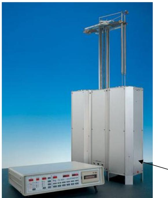
Рисунок 1 – внешний вид дилатометра
