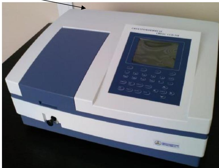
Рисунок 1 - Общий вид спектрофотометров СПЕКС ССП
