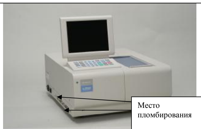
Рисунок 2 – Схема пломбирования от несанкционированного доступа
