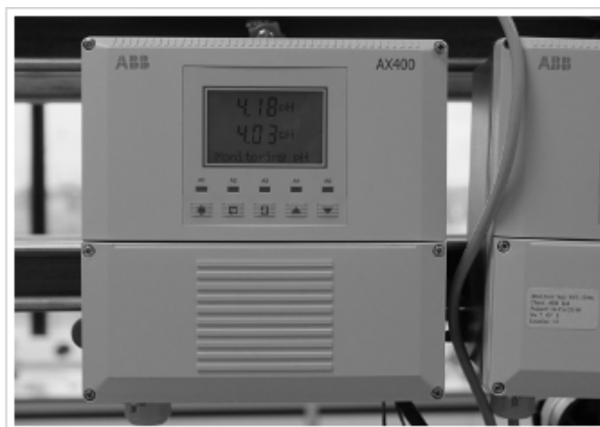
Рис. 1. Фотография внешнего вида анализатора жидкости AX400.
