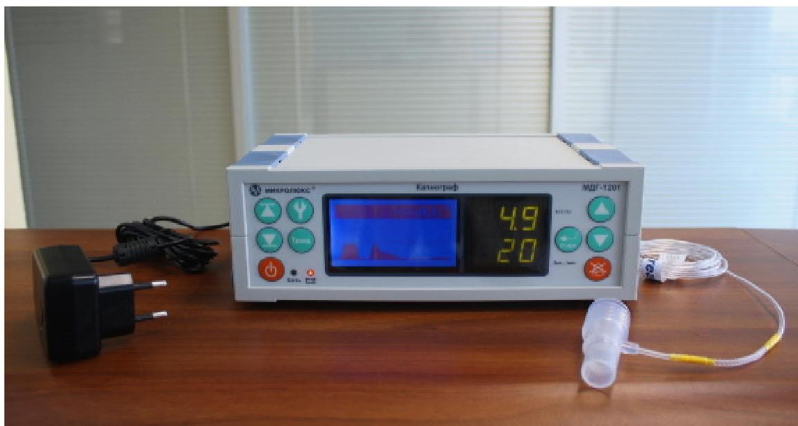
На передней панели монитора располагаются ЖК-дисплей и органы (кнопки) управления и индикации. На задней панели монитора размещены: разъем подключения адаптера питания, входной и выходной порты  $\text{CO}_2$ .
