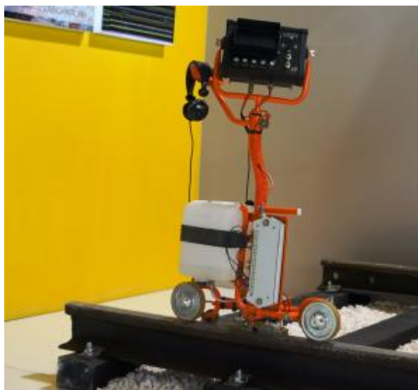
Рисунок 1 – Общий вид Дефектоскопа ультразвукового однопиточного «СКАТ», установленного на рельсы
