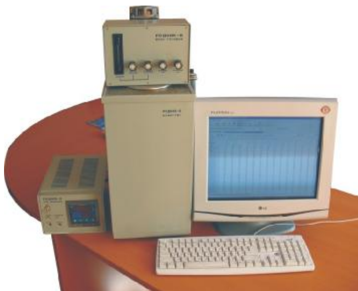
Рисунок – Генератор влажного газа эталонный РОДНИК-6
