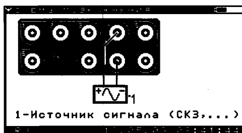
Рисунок 2.8.5.2 – Окно «Схема подключения прибора при снятии осциллограмм»
