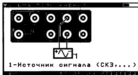
Рисунок 2.8.4.1 – Окно «Схема подключения прибора при проведении измерений»
