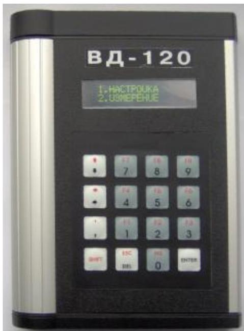
Рисунок 1 - Внешний вид дефектоскопов вихретоковых портативных ВД-120.
