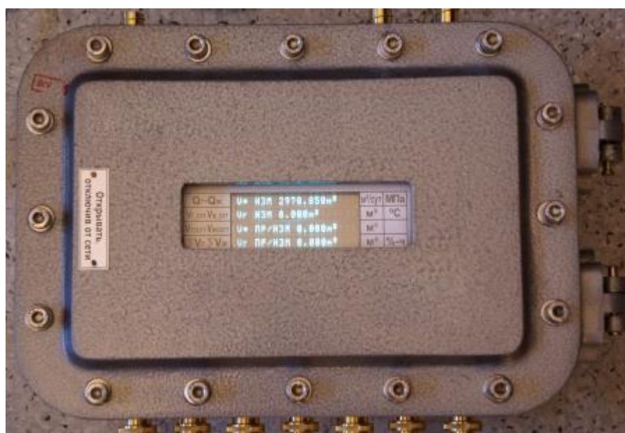
Рисунок 2 - Фотография блока измерений и обработки информации БИОИ
