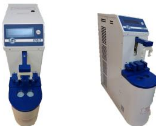
Рисунок 1 - Общий вид прибора ПЧП-7 для определения числа падения
