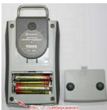
Рисунок 2 – Место пломбирования дозиметра
